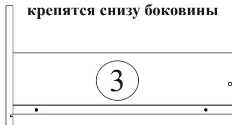
ЛДВП прибивается, после прикручивания шариковых направляющих
